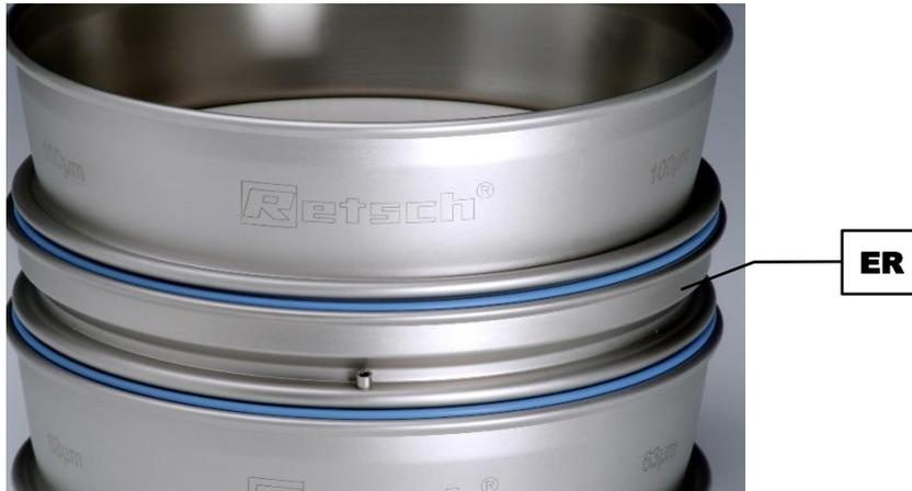
Abb. 19: Entlüftungsring
